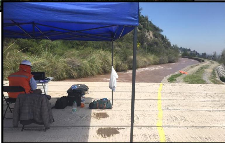
A través de la instrumentación, podemos obtener el tiempo de pasada (y por lo tanto la velocidad), y la concentración de trazador en el canal (y por balance de masa el caudal)
